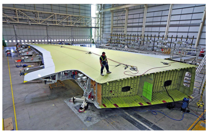
AIRBUS A380 翼のボルト数: およそ 160,000 bolts
